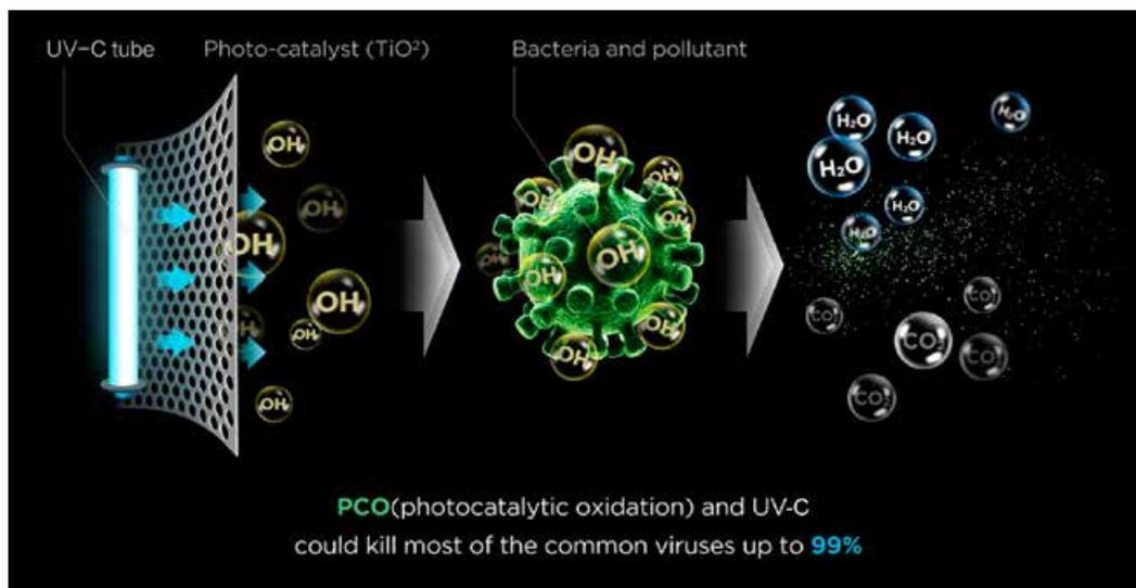
La oxidación fotocatalítica (PCO) se inicia cuando la radiación UV-C activa la capa de dióxido de titanio (TiO<sub>2</sub>) y desencadena dos reacciones químicas que conducen a la formación casi instantánea de radicales hidroxilo y aniones superóxido. Estos agentes químicos altamente reactivos interactúan instantáneamente con todos los contaminantes orgánicos a través de la oxidación, para acelerar su descomposición ambientalmente beneficiosa.
