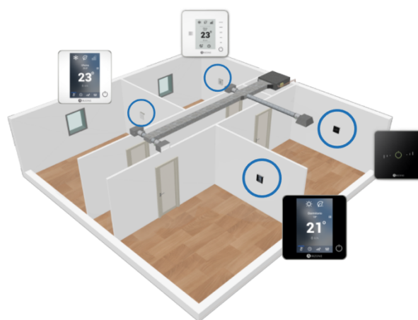
Figura 1. Esquema de un sistema zonificado.
